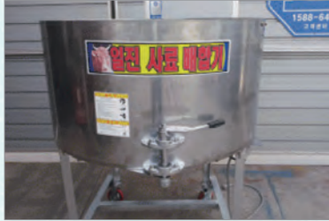
사료 배합기 ເຄື່ອງປະສົມອາຫານສັດ ສາລິ ແບບເຮັດໃຫ້ສາລິ ທຸກຢ່າງ. ໃສ່ອາຫານສັດ ໃນເຄື່ອງປະສົມອາຫານສັດ.
